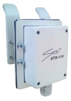
Извещатель охранный вибрационный STS-119 (далее извещатель) предназначен для осуществления контроля за целостностью оконных решеток, для обнаружения попыток разрушения и/или перемещения физических заграждений в виде металлических решеток изготовленных из металлического прутка диаметром 8-24 мм. Контролируемая площадь решетки не более 25 кв.м. Извещатель конструктивно выполнен в металлическом корпусе и имеет светодиодную индикацию режимов работы.
