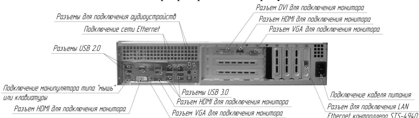
Рисунок 1 – Подключение видеосервера (расположение, внешний вид и количество разъемов может отличаться от приведенного)
