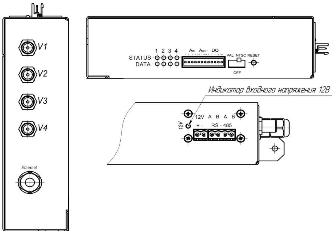
V1-V4 – Разъемы для подключения аналоговых видеокамер
