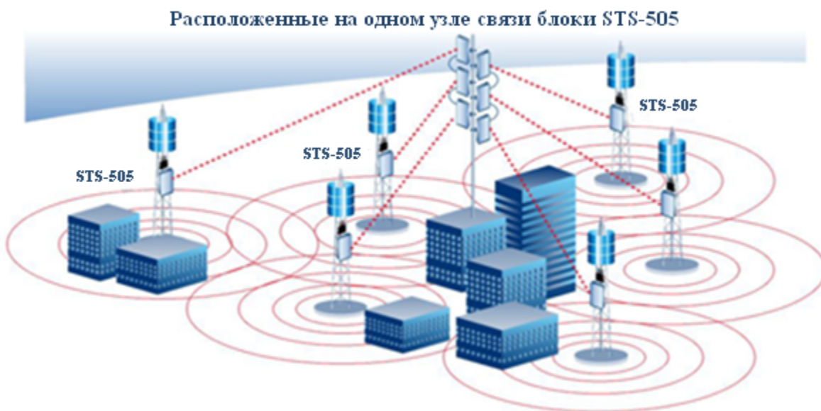
Рис. 1-3: Типовое применение для организации транспортных каналов WiFi
